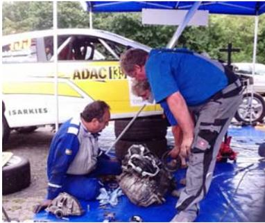
Getriebeschäden bei Scheidhammer
