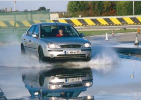
Von Aquaplaning bis Schnelllauf: In elf Testdisziplinen mussten sich die Testkandidaten bewähren. Getestet haben wir alle Reifen auf einem Ford Mondeo – unserem Referenz-Fahrzeug
